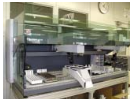
家畜改良技術研究所で使用されている Freedom EVOワークステーション
