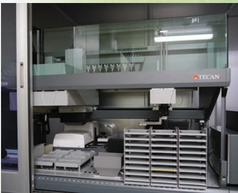
ハイドロスピード プレートウォッシャーとインフィニット F200 PRO プレートリーダーを搭載した Freedom EVO ワークステーション
